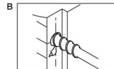
在其中心鑽直徑25.4mm (1")、13mm (1/2")深孔，依檔板之外緣記號鑿1.6mm (1/16")深，使檔板與門框保持在同一平面上。
