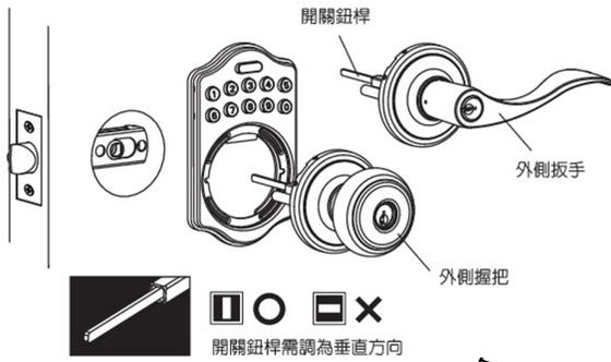
b. IC排線經由鎖門上方穿過鎖體安裝孔。
