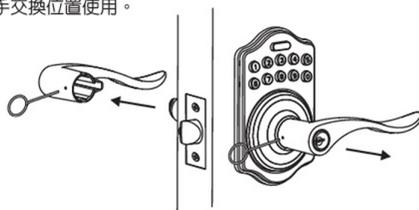
b. 將鎖組裝回外側扳手並對準驅動管的缺口開槽，再將把手推入使其固定。確認扳手已確實固定，並測試鎖組轉動是否正常。
