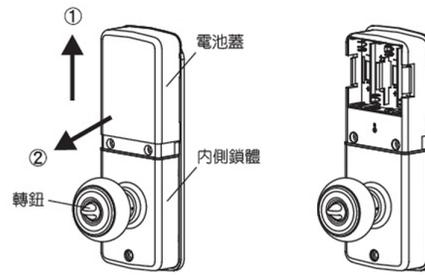
b. 連接內外排線。將內側鎖體對準開關鈕桿放入(轉鈕呈水平)，並以固定螺絲將內側鎖體固定。木槓螺絲可依需求決定是否安裝。(木槓螺絲僅適用於木門)
