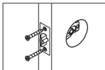
裝入鎖門並用螺絲固定。確認支撐螺絲孔之高度需保持水平一致。
